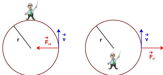
U najnižoj točki napetost užeta jednaka je zbroju težine utega  $G$  i centrifugalne sile  $F_{cf}$ . Znači da čvrstoča užeta u najnižoj točki mora biti jednaka ili veća od
