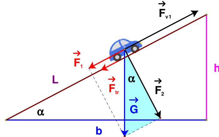
Kada se automobil giba uzbrdo po kosini starnom brzinom  $v_1$  vučna sila  $F_{v1}$  motora jednaka je zbroju komponente sile teže  $F_1$  i sile trenja  $F_{tr}$ . Ona se troši na svaldavanje komponente sile teže  $F_1$  i sile trenja  $F_{tr}$ .
