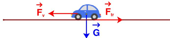
Na horizontalno postavljenom putu automobil se giba starnom brzinom  $v$  pa je vučna sila  $F_v$  po iznosu jednaka sili trenja  $F_{tr}$ .
