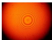
Newtonova stakla sastoje se od plankonveksne leće velikog polumjera zakrivljenosti R koja je položena na planparalelnu ploču. Između leće i ploče nastaje tanak zračni klin. Kod Newtonovih stakala dobiju se u monokromatskoj (jednobojnoj) svjetlosti tamni i svijetli kolobari. Polumjer k-tog svijetlog kolobara je
